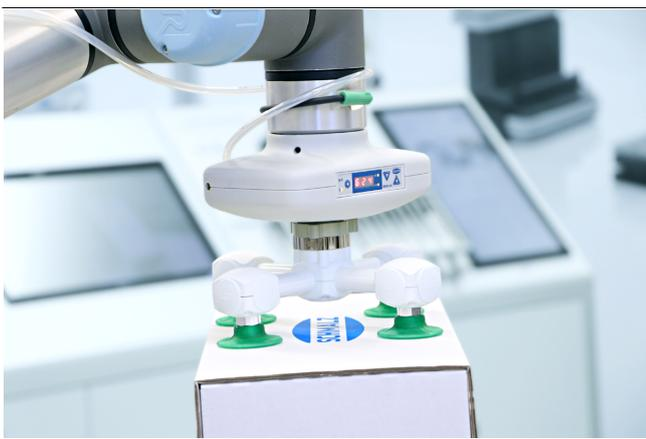
Pneumatischer Vakuum-Erzeuger RECB bei der Handhabung von Kartonagen
